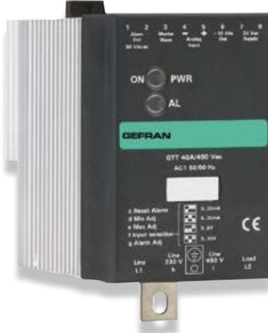
Grupo estático de potencia monofásico, para el mando de cargas resistivas, equipado con radiador para la disipación del calor; disparo "fast-cycling, zero-crossing" para el pilotaje del doble SCR conectado en antiparalelo; mando analógico proporcional con señal 0...10 Vca, 0...20 mA, 4...20 mA, potenciómetro. Fijación para carril DIN; led de indicación y diagnóstico.
