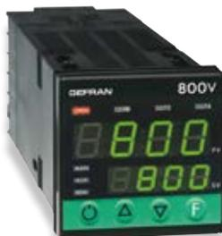
Regulador de microprocesador para válvulas motorizadas, protección frontal IP65, entrada universal, precisión 0,2% f.s., regulación calor-frío, salidas abrir/cerrar relé, de hasta 2 salidas relés de alarma, 2 entradas digitales configurables, entrada punto de consigna remoto, línea serie RS485/RS232C Modbus o Cencal, 3 alarmas, alarma carga interrumpida, autosintonía, sintonía automática, arranque suave, manual/auto con bumpless, local/remoto, multiset, rampa de ajuste, temporizador interno.
